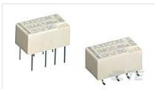
TE Part #6-1462037-0 IM43JR=IM RELAY 100mW 5V BIS
