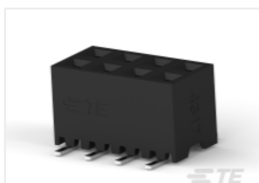
TE Part # 2307819-8 8P,2MM,BB,REC,DRVVT,SMD,AU.76,TR, W/CP
