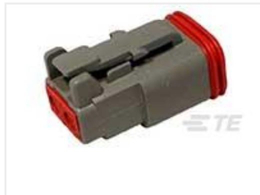
TE Part #DT06-2S PLG, 2P, GRY, N
