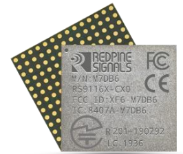
LGA Module (CC0) 9.10 mm X 9.80 mm
