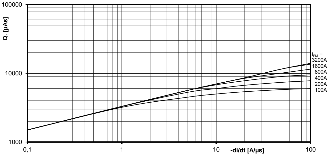
Sperrverzögerungsladung / Recovered charge Q_r = f(-di/dt)
