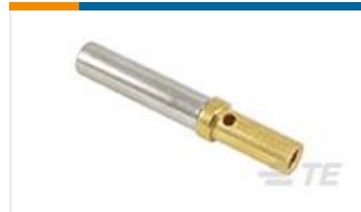
TE Part # 0462-201-1631 SOC, SOLID, SIZE 16, 16-20AWG, AU
