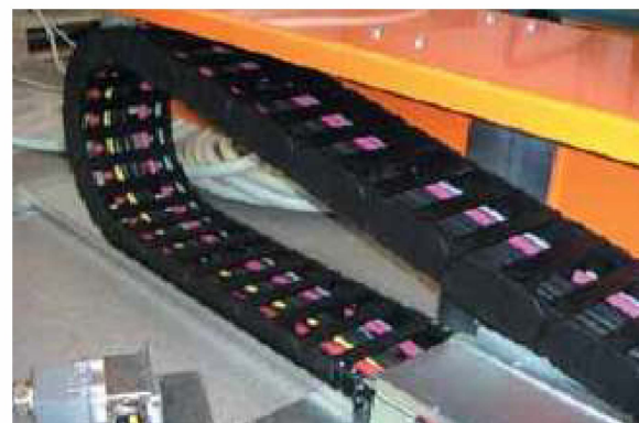
Przewody CF2 są odporne na oleje i chłodziwa. e-prowadnik: System E4/00
